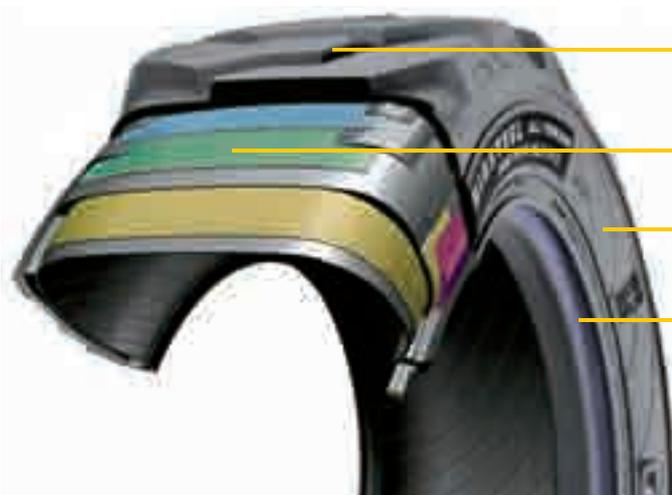
Bande de roulement très ouverte optimisant la traction et l'auto nettoyage.
