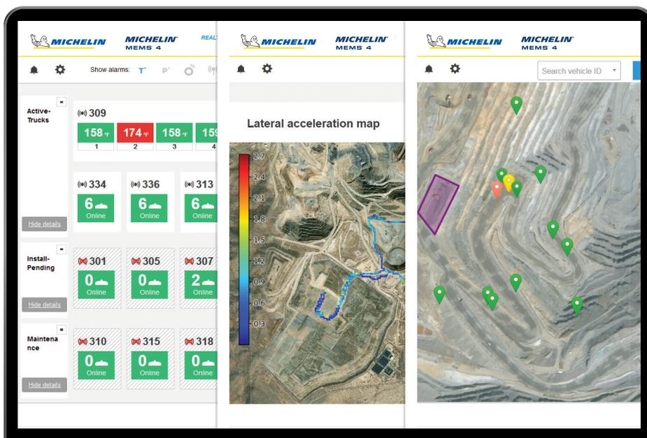
Suivi des alertes de température et de pression grâce au tableau de bord convivial.
