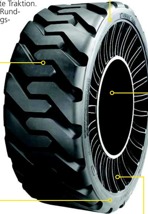
Die bei der Produktion des MICHELIN X-TWEEL SSL verwendeten Technologien (Lauffläche in Radialbauweise mit 0-Grad Gürtel) sind garant für eine ausgezeichnete Seitenstabilität und eine hohe Resistenz gegen Anprall- und Stichverletzungen.
