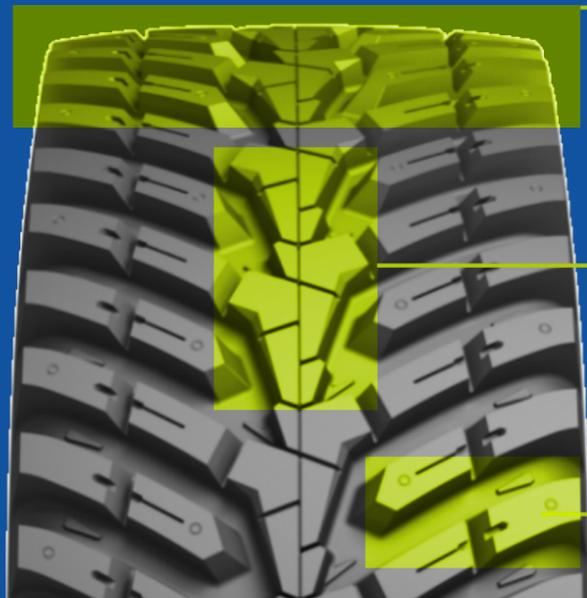
✓ La large empreinte au sol combinée à la partie centrale de la bande de roulement plate procure une faible résistance au roulement et une consommation de carburant moindre.
