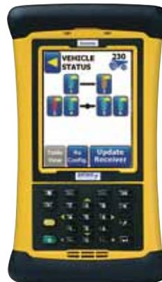
Das Michelin Earthmover Management System – kurz MEMS – ist die erste Anlage zur Fernüberwachung von Fülldruck und Temperatur an Fahrzeugreifen, die im Tagebau eingesetzt wird.
