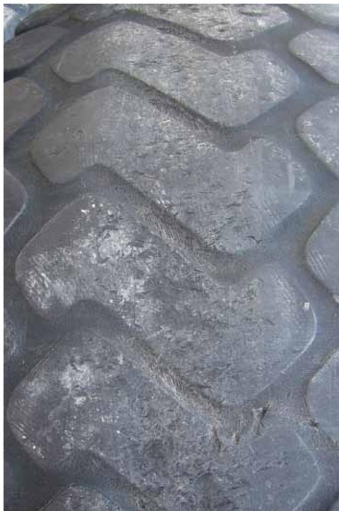
Spätestens wenn das Profil nicht mehr zu sehen ist, sollte der Reifen demontiert werden.
