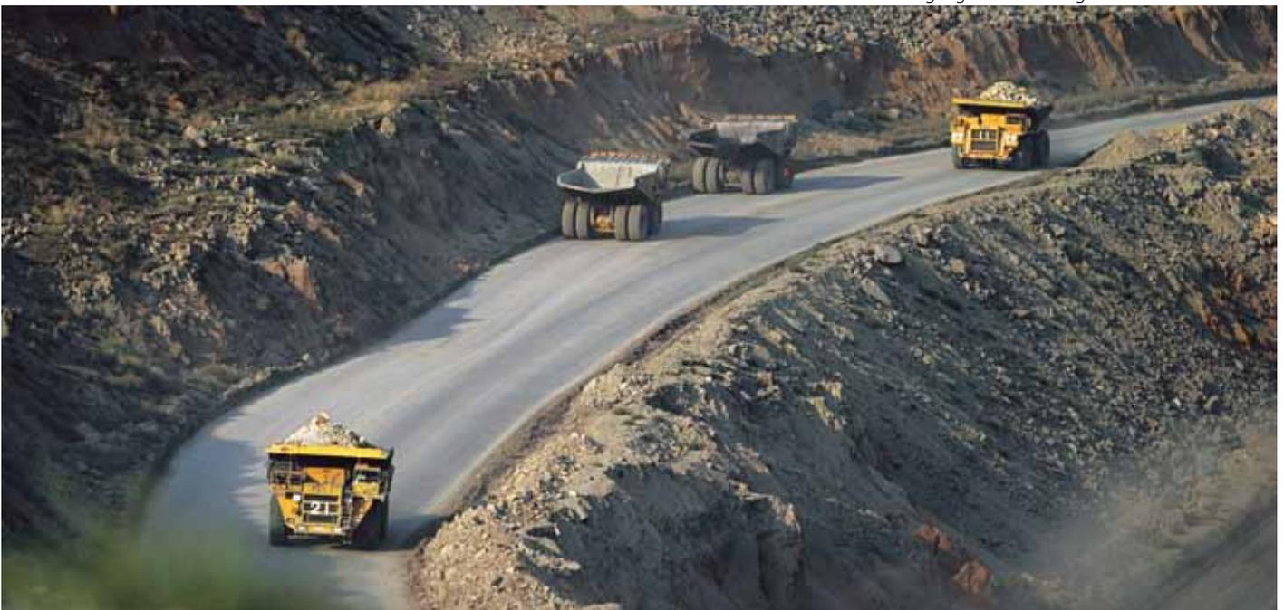
Bei langen Umläufen ist das Risiko einer Reifenüberhitzung (bei gleicher Last und Geschwindigkeit) höher.
