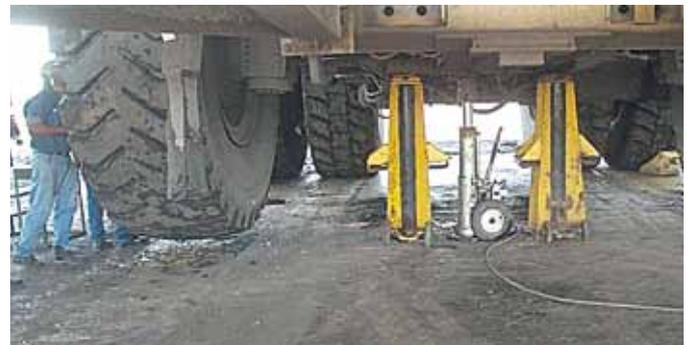
Die Einstellung der Spurwerte erfolgt am aufgebockten Fahrzeug.
