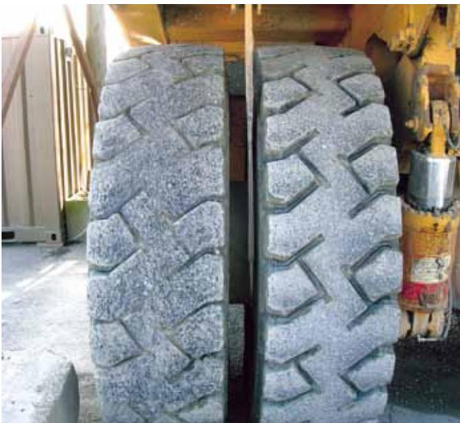
Die beiden Reifen einer Zwillingseinheit dürfen keinen unterschiedlichen Abnutzungsgrad aufweisen.
