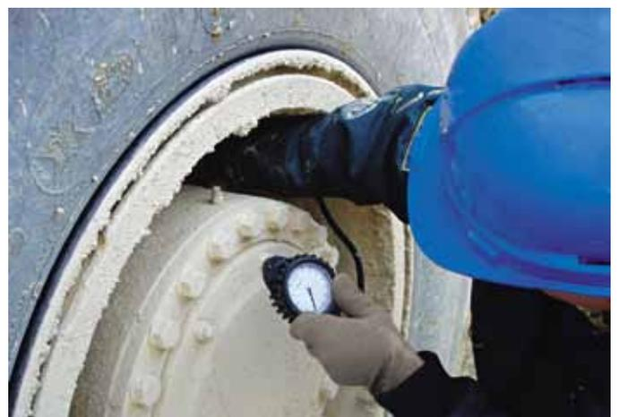
Bei kalten Reifen darf der Reifenfülldruck nicht über bzw. unter 10 % des empfohlenen Luftdruckwertes liegen.
