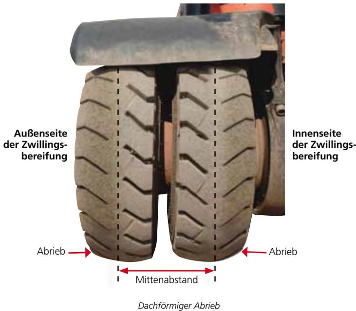
Die beiden Einzelreifen einer Zwillingsereinheit weisen manchmal einen dachförmigen Abrieb auf. Dabei ist der Verschleiß an der Außenschulter höher als im Innenbereich. Im Extremfall müssen derart an der Schulter abgefahrene Reifen außer Betrieb gesetzt werden, obwohl der Zustand der Lauffläche die Fortsetzung des Einsatzes am Fahrzeug durchaus erlauben würde.
