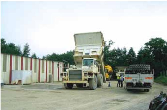
Die Fahrzeuge sind auf ebener Fläche in einem frei geräumten, befestigten und sauberen Bereich abzustellen.
