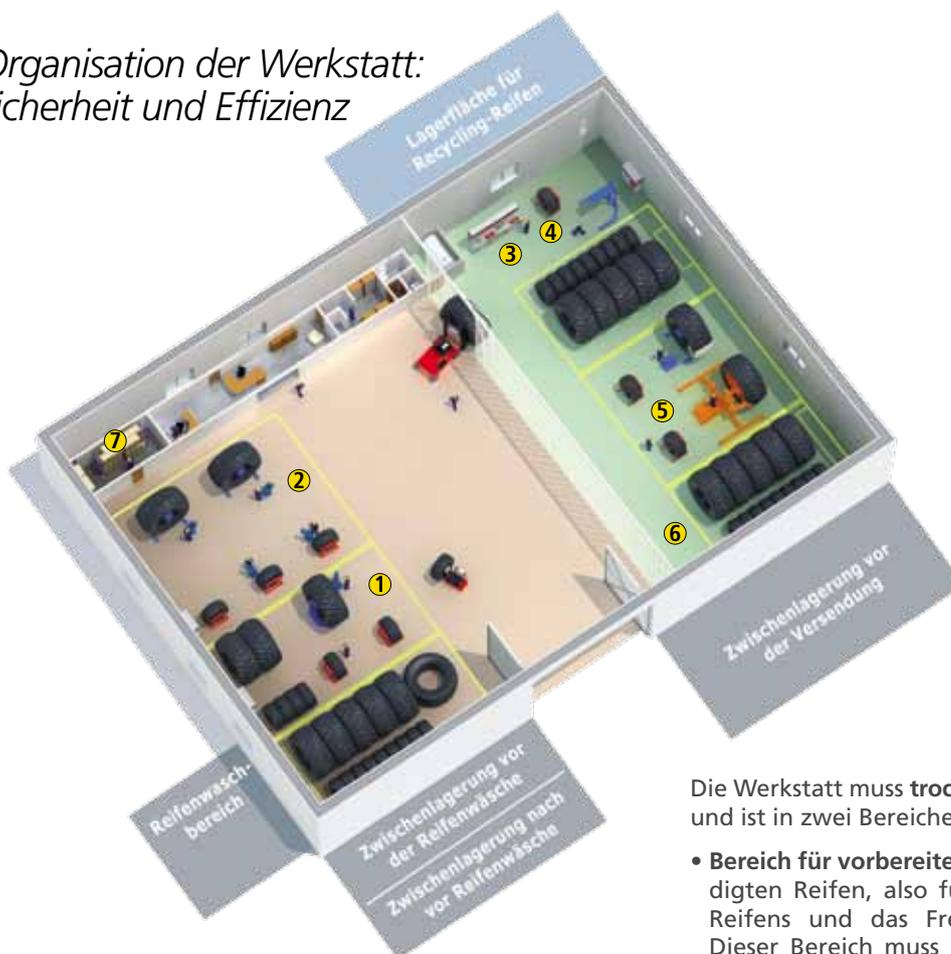
■ Bereich für vorbereitende Arbeiten am beschädigten Reifen
