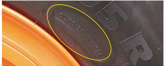
Montage eines laufrichtungsgebundenen Reifens: Der Vermerk "outside vehicle" muss sichtbar sein
