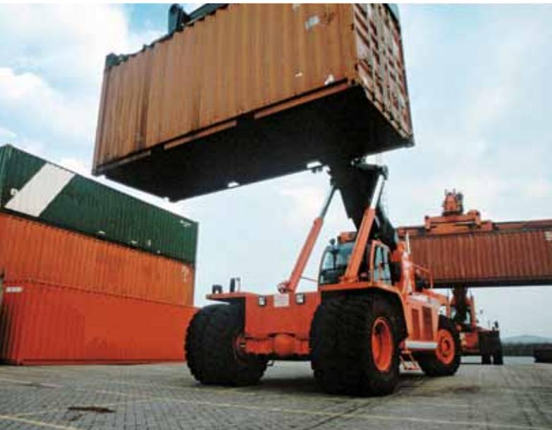
Eine Zwillingsbereifung wird für Fahrzeuge eingesetzt, die schwere Lasten tragen müssen.
