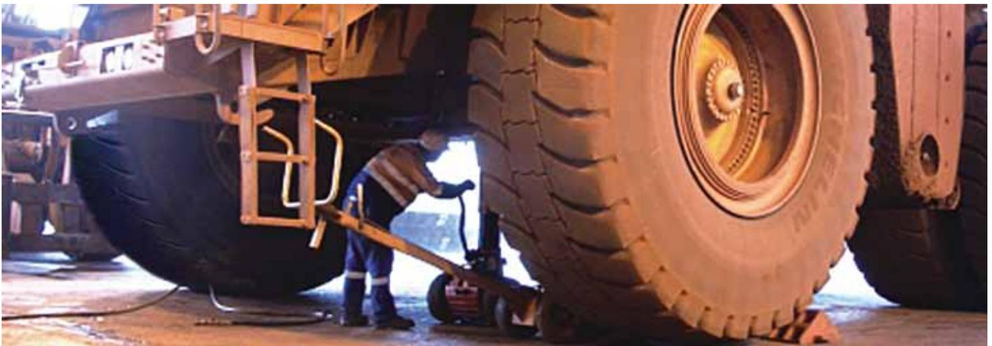
Zur Einstellung der Aufhängung muss das Fahrzeug aufgebockt werden.
