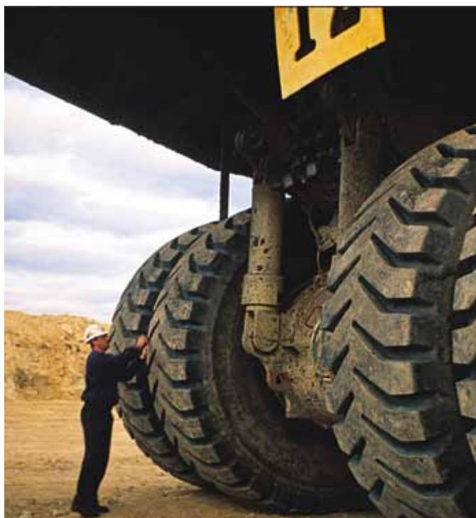
Stellen Sie sicher, dass zwischen den Reifen einer Zwillingseinheit kein Gegenstand eingeklemmt ist.
