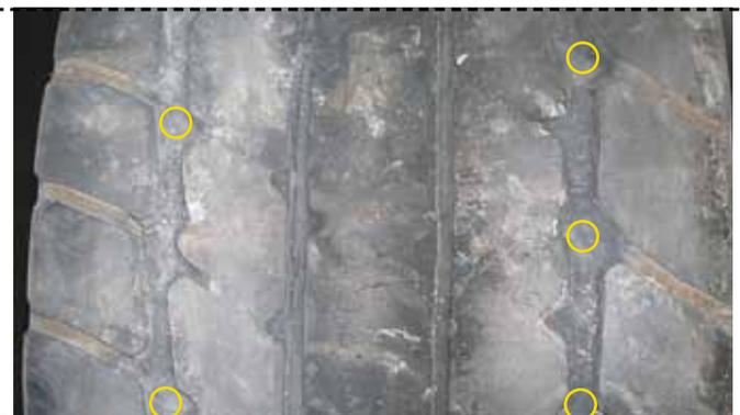
MICHELIN X-CRANE: Hier wurden die Stege an den Schultern und die mittleren Längskanäle nachgeschritten. Die Mittelstege und äußeren Längskanäle sind nicht nachgeschritten worden.
