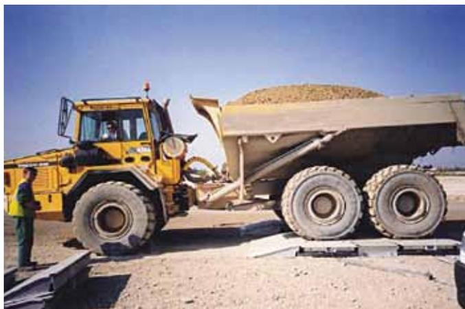
Wiegen der Hinterachsen eines knickgelenkten Dumpers.
