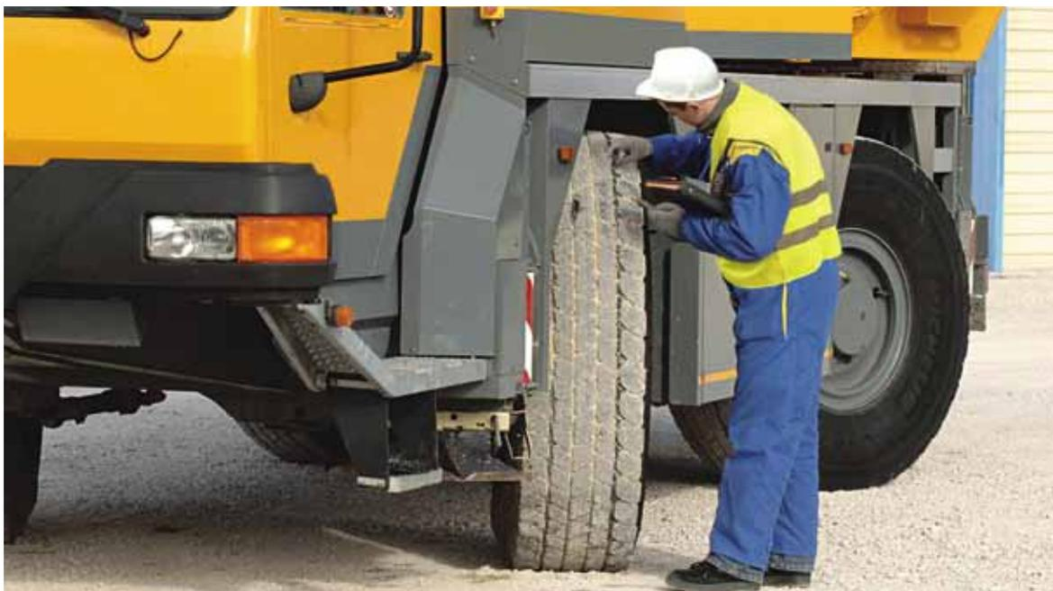
Beginnen Sie die Inspektion mit dem linken Vorderrad und umrunden Sie das Fahrzeug im Uhrzeigersinn.
