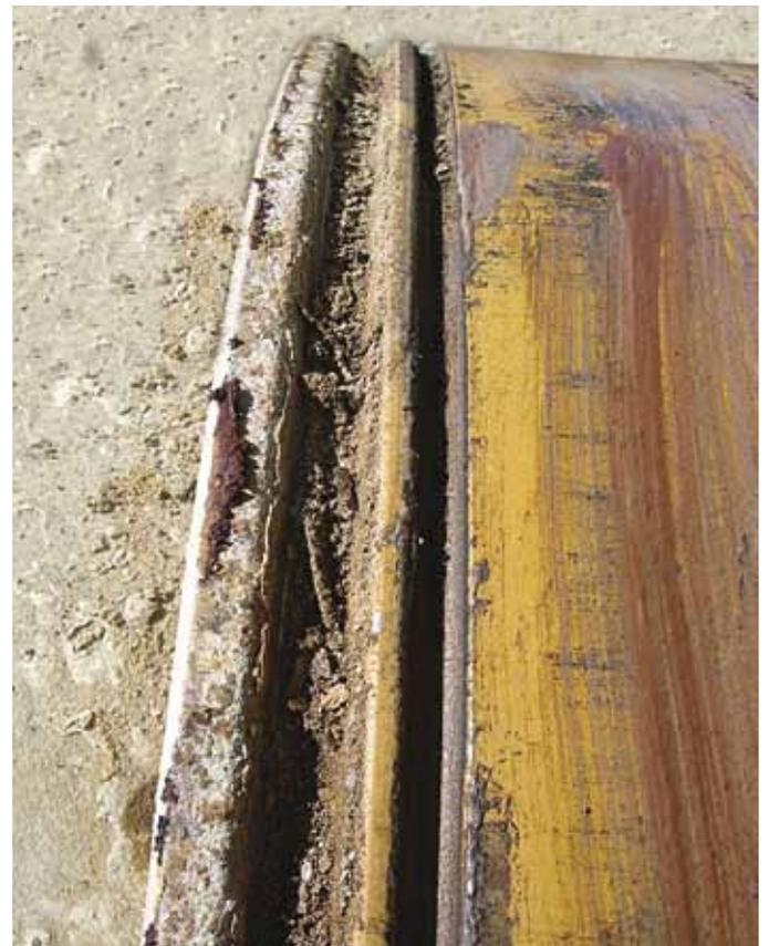
Alle Felgenbestandteile sind zu reinigen
