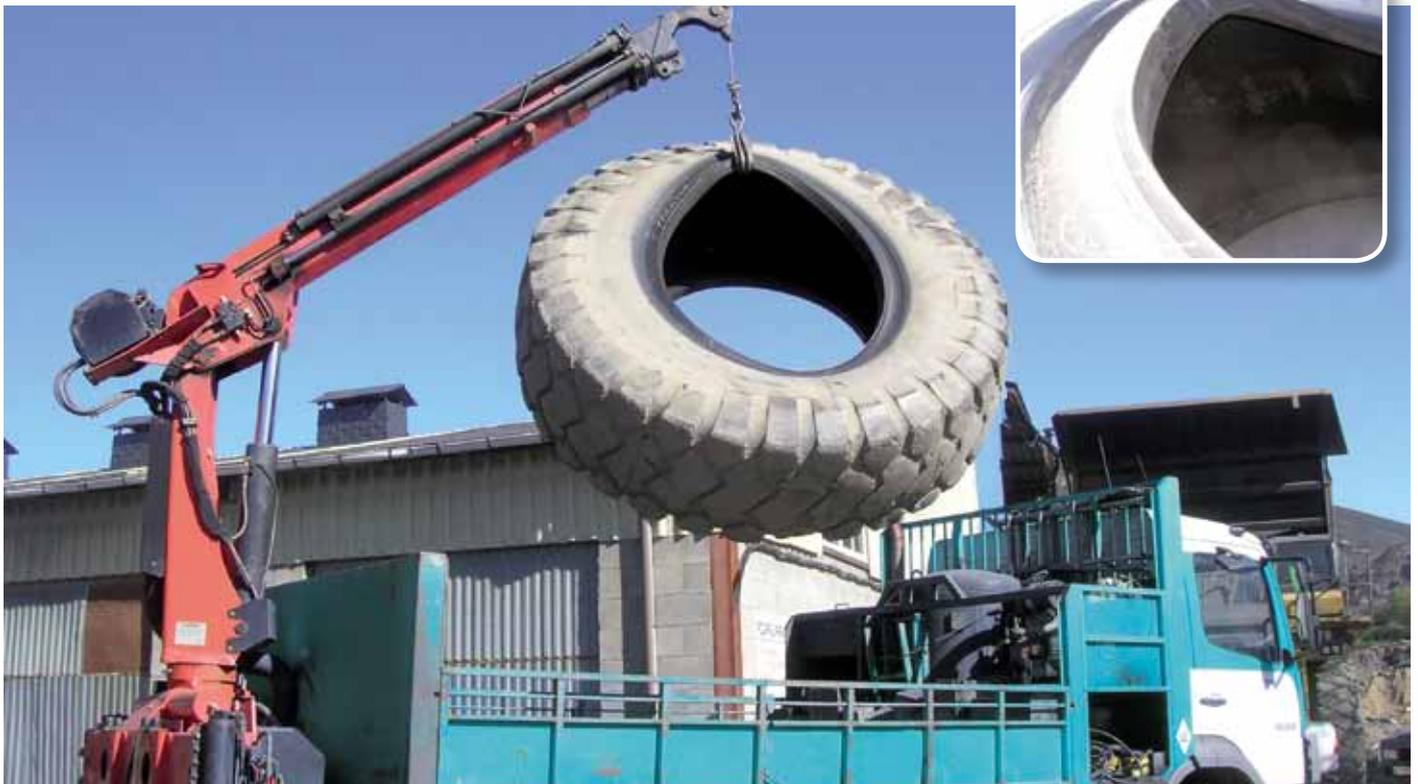
Unsachgemäßes Handling kann irreparable Schäden am Reifen verursachen.
