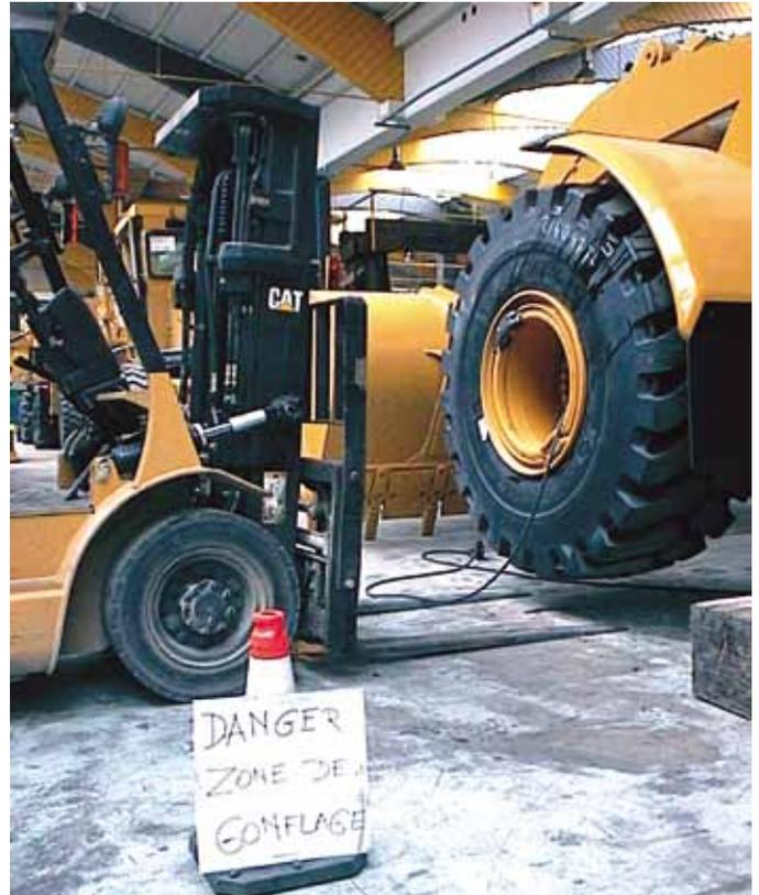
Befüllen am senkrecht aufgestellten Reifen. Der Arbeitsbereich ist abgesichert (im Falle eines Umher­schleuderns von abnehmbaren Felgenteilen).
