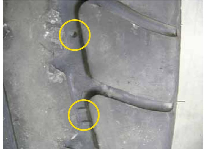
MICHELIN X-CRANE: Nachschneideindikator (oben), Verschleißindikator (unten)
