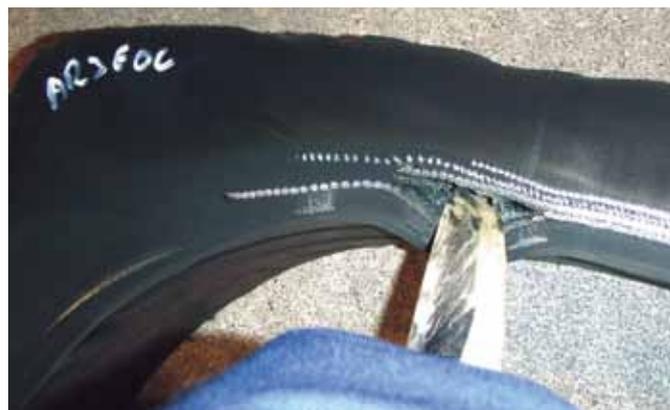
Trennung der Bestandteile in einem Reifen
