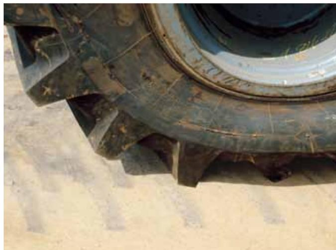
Ein unzureichender Reifenfülldruck schadet der Langlebigkeit von Reifen.
