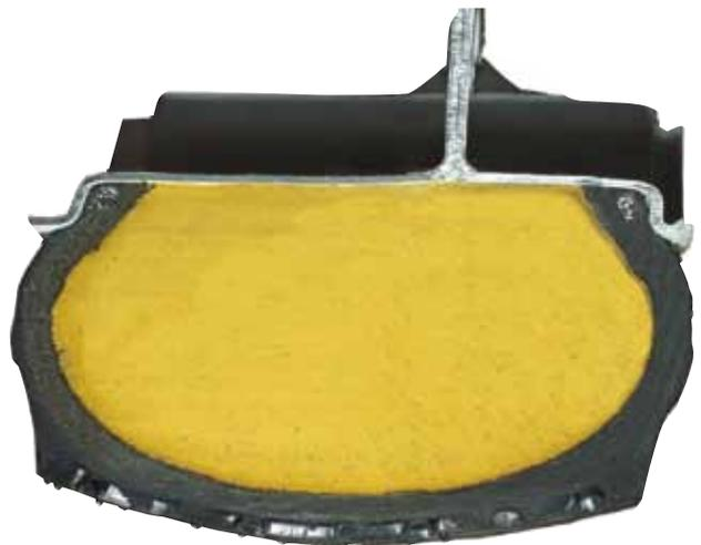
Schaumfüllungen aus Polyurethan (PU)
