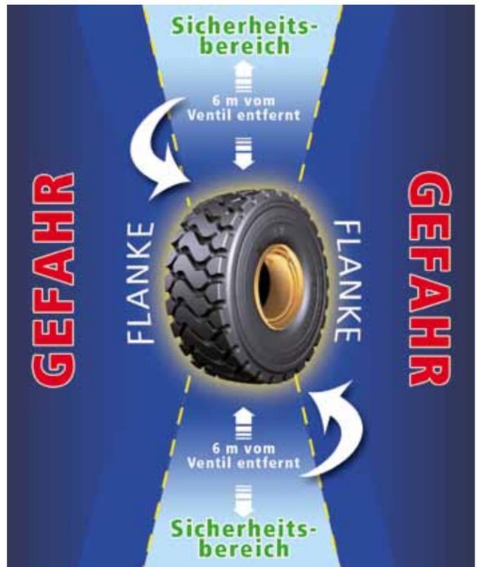
Beim Aufpumpen sollte sich der Monteur unbedingt in der Verlängerung der Reifenlauf­fläche aufhalten.
