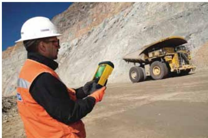
Sind die Räder mit Luftdrucksensoren ausgerüstet, kann der Luftdruck ohne Stopp des Fahrzeugs aus der Entfernung gemessen werden.
