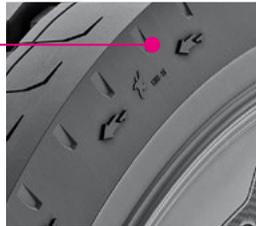
Sin embargo, si una llanta marcada con flechas bidireccionales muestra un desgaste irregular atribuible a esta condición, esta puede ser puesta a girar en la dirección de la flecha más pequeña y no mostrar disminución en el desempeño. En estos casos, Michelin recomienda que todas las llantas de un mismo eje sean puestas a girar en la misma dirección.
