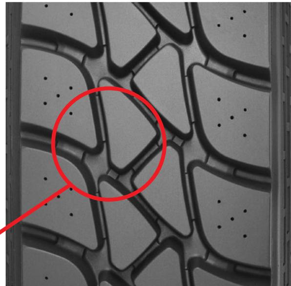
FMVSS -119 Section (c) et le règlement fédéral américain sur la sécurité des transporteurs routiers 393.75 indiquent que les pneus qui ne sont pas sur l'essieu directeur doivent avoir une profondeur de sculpture d'au moins 2/32e lorsque mesuré dans une rainure principale de la bande de roulement. **La mesure ne doit pas être effectuée à l'endroit des barres d'encrage, des bosses ou des filets.** »
