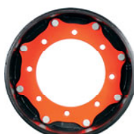
Adaptateur de jante MSPN 47862 / CAI 481115 12 mm d'épaisseur 1015 Carbone Acier / Réversible Dia. central 228,6 mm (9,0 po) Boulon 8 x 10,75 po Ouvertures de boulons 17 mm (0,67 po), biseau Pour montage sur les équipements Bobcat
