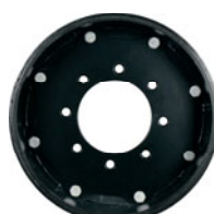
Adaptateur de jante MSPN 47868 / CAI 291074 12 mm d'épaisseur 1015 Carbone Acier / Réversible Dia. central 152,4 mm (6,0 po) Boulon 8 x 8,0 po Ouvertures de boulons 17 mm (0,67 po), biseau Pour modifier le déport de la jante d'une dimension standard
