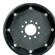
Adaptateur de jante MSPN 04630 / CAI 336820 12 mm d'épaisseur 1015 Carbone Acier / Réversible Dia. central 93,5 mm (3,68 po) Boulon 10 x 140 mm Ouvertures de boulons 16 mm (0,63 po), biseau Pour les chariots élévateurs embarqués
