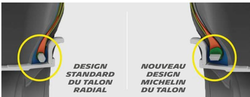
Une zone de talon plus robuste et une structure<sup>(2)</sup> du pneu renforcée permettent ensemble une capacité de charge améliorée.
