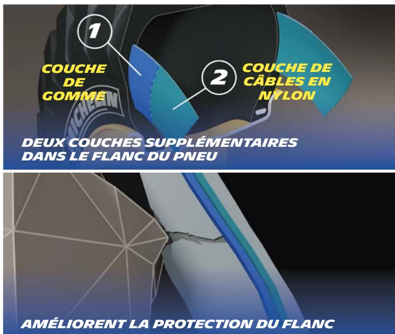
De nouveaux câbles carcasse et des couches renforcées sur le côté augmentent la protection des flancs.
