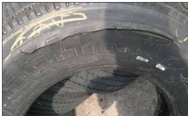
Rupture due à l'usure fatigue ou « zipper »
