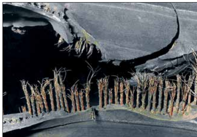
EFFET : Tout dommage qui permettra à la carcasse de s'oxyder CAUSE : Humidité
