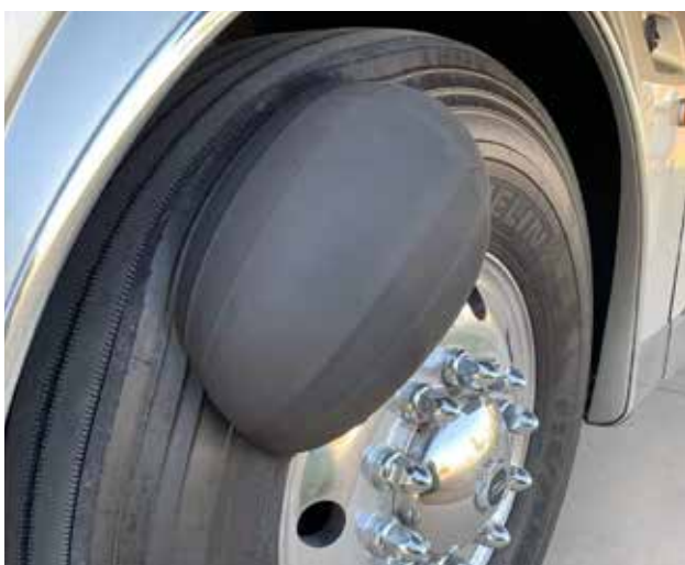
EFFET : Dommages au revêtement intérieur CAUSE : Défaillance fonction roulage à plat ou verrou de talon défectueux
