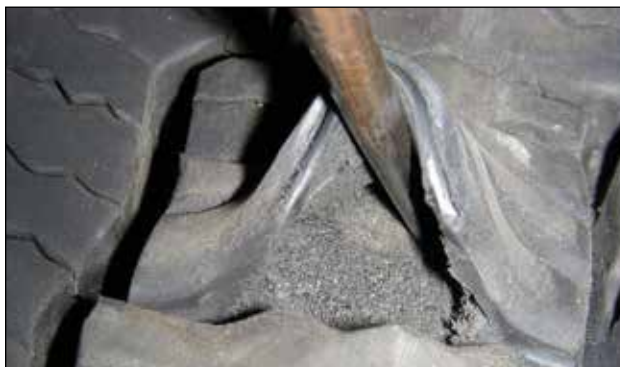
EFFET : Détérioration interne du caoutchouc de la bande de roulement CAUSE : Utilisation prolongée du dynamomètre
