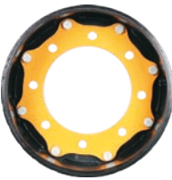
Adaptateur de jante MSPN 47139 CAI 419992 12 mm d'épaisseur 1015 acier carbone / réversible Diamètre central 222,3 mm (8.75") Boulon 8 x 10.91" Ouverture de boulons 20 mm (0.79"), sans biseau Pour montage sur les retrochargeuses de marque CASE
