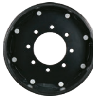
Adaptateur de jante MSPN 47868 CAI 291074 12 mm d'épaisseur 1015 acier carbone / réversible Diamètre central 152,4 mm (6.0") Boulon 8 x 8.0" Ouverture de boulons 17 mm (0.67"), avec biseau Utilisez un adaptateur pour modifier le déport de la jante d'une dimension standard en 8 x 8.0".
