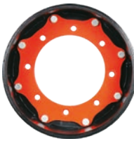
Adaptateur de jante MSPN 47462 CAI 481115 12 mm d'épaisseur 1015 acier carbone / réversible Diamètre central 228,6 mm (9.0") Boulon 8 x 10.75" Ouverture de boulons 17 mm (0.67"), avec biseau Pour montage sur divers véhicules BOBCAT
