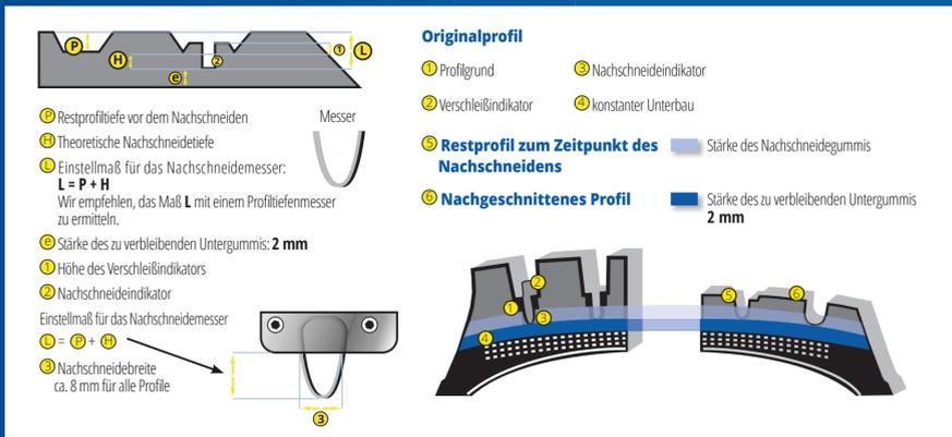
Die Nachschneidetiefe beträgt für alle hier aufgeführten Profile 3 mm wenn nicht anders angegeben. Unsere aktuellen Profile geben die mögliche Nachschneidetiefe zur besseren Einstellung der Tiefe des Nachschneidmessers bereits mit den Nachschneideindikatoren in den Verschleißindikatoren vor.
