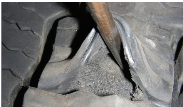
EFFET : Détérioration interne du caoutchouc de la bande de roulement CAUSE : Utilisation prolongée du dynamomètre
