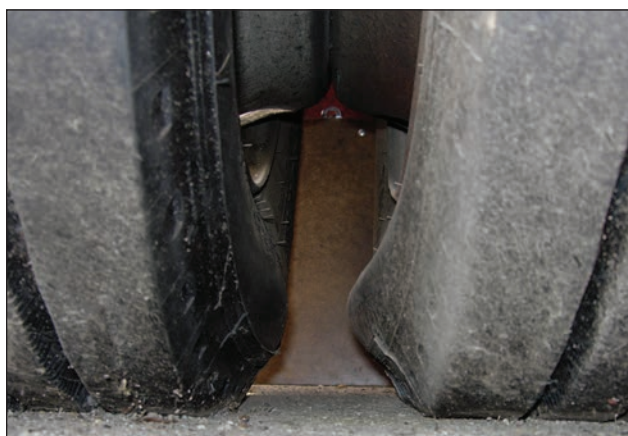
Le sous-gonflage dans une configuration double surcharge le pneu correctement gonflé. Les deux pneus doivent être inspectés.
