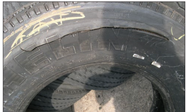
Rupture due à l'usure fatigue ou « zipper »
