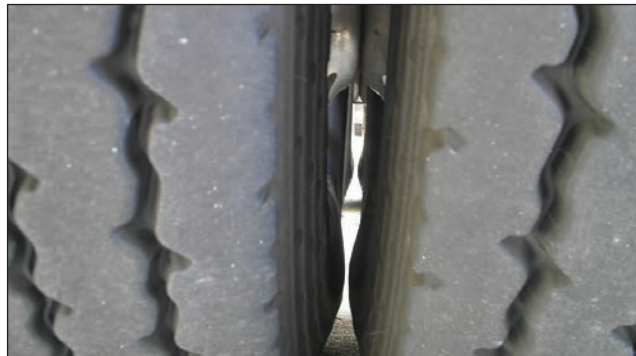
EFFET : La friction affaiblit considérablement la carcasse CAUSE : Contact des pneus en configuration double (dual kissing)
