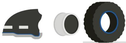
Bei der Quick Heel-Technologie ist die Anpassung an die Felgenkontur perfekt ausgebildet und somit Vollkontakt ohne zusätzliche Sicherungselemente gewährleistet.
