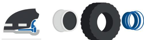
Les talons standards nécessitent plusieurs composantes de verrouillage pour être maintenus en place : l'anneau conique, le cercle latéral et l'anneau de verrouillage.
