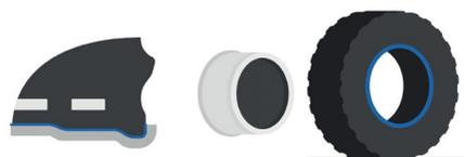
Les talons Quick sont conçus pour épouser parfaitement la jante, assurant un contact complet sans nécessité de composantes de verrouillage supplémentaires.
