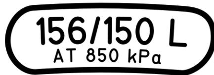
• Esempio di indici di carico e di velocità
