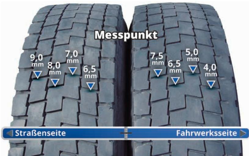
Einige Lkw-Reifen haben eine Rollrichtung, die zu Beginn ihrer Lebensdauer eingehalten werden sollte, um die Profilkonstruktion zu optimieren. In diesem Fall ist es notwendig, alle Reifen der Achsen zu tauschen und zu drehen, um die gleiche Rollrichtung beizubehalten.
