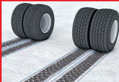
Bei zu hohem Reifenfülldruck wird die Aufstandsfläche kleiner, da der Reifen nur in der Laufflächenmitte trägt. Die Reifenschultern wirken nicht oder nur teilweise mit. Dadurch sind weniger Profilkanten im Eingriff. Die Traktion nimmt ab und die Reifen drehen schneller durch. Das geringere Einfederungsverhalten führt dazu, dass sich die Profiltrillen schneller mit Schnee zusetzen und die Gesamtleistung abnimmt.
