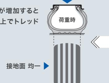
荷重を受けるとサイドウォールのみがたわみ、堅固なスチールベルトで形成されているトレッドは独立した安定性を維持する。
