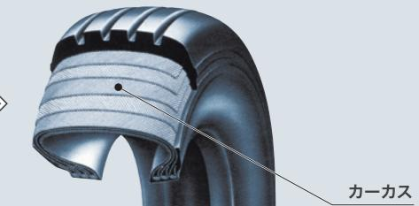
接地面圧が均一でない。荷重が増加すると接地面上でトレッドゴムが動く(すべる)。
