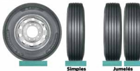
**INAPPROPRIÉ : Un pneu ou seulement une partie d'un pneu soutient la pleine charge.**
