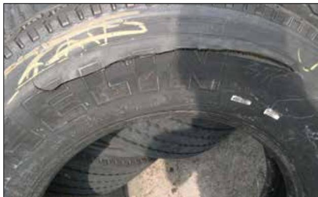
**Rupture due à l'usure fatigue ou « zipper »**
