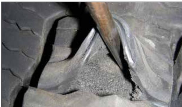
**EFFET : Détérioration interne du caoutchouc de la bande de roulement**
