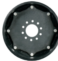
Adaptateur de jante MSPN 04630 CAI 336820 12 mm d'épaisseur 1015 acier carbone / réversible Diamètre central 93,5 mm (3.68") Boulon 10 x 140 mm Ouverture de boulons 16 mm (0.63"), avec biseau Pour divers chariots élévateurs embarqués
