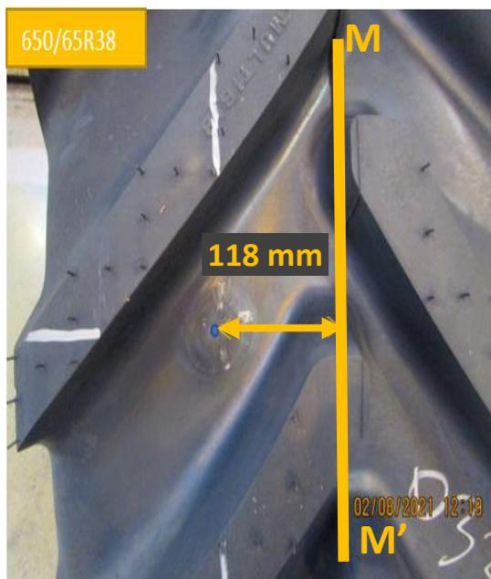
Um die Messunsicherheit und die kritische Differenz zu verringern, führen wir für jeden Reifen zwei Perforationen im Abstand von 180° durch, so dass wir **für jeden Reifen zwei Energiewerte erhalten.**
