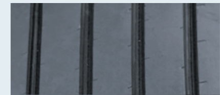
リグループ実施後 更に最大4ミリの新たな溝を得る事が出来る
