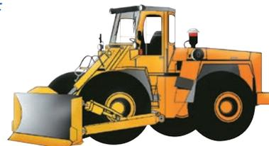
De façon pratique, on admet dans chacun des deux cas que la charge maximale supportée par l'essieu le plus sollicité représente les 2/3 du poids en ordre de marche de l'engin.
