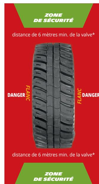
\*Lors du gonflage se tenir sur le côté du pneu (zone de sécurité en couleur verte) et utiliser un manomètre disposant d'une longueur de tuyaux d'un minimum de 6 mètres.
