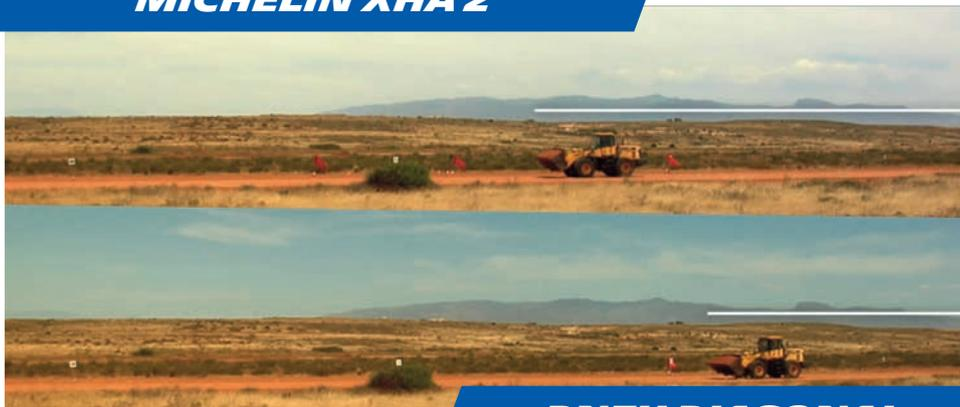
2 machines sont lancées à 30 km/h. Après débrayage du moteur, on mesure la distance parcourue. La machine, équipée en pneus MICHELIN, subit moins de résistance au roulement, donc consomme moins de carburant. Tests effectués dans notre centre de recherche et développement à Alméria en Espagne.
