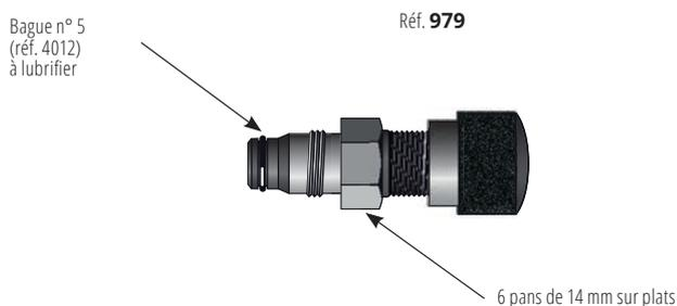
Valvage en bout du crochet **type A2** et sur **embase américaine SP2** (peut remplacer la valve **TRJ 670**).
