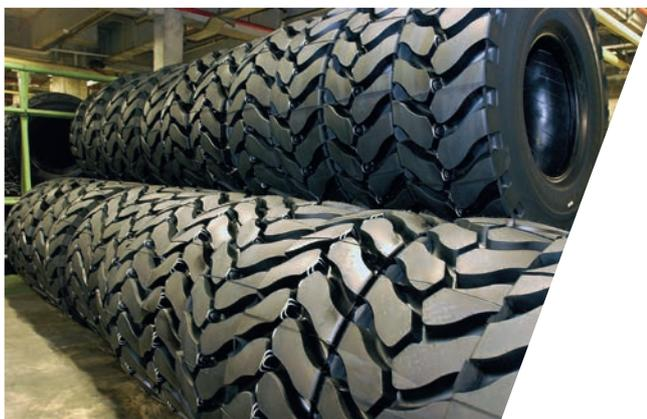
Les gommages du pneu, à base de caoutchouc, sont sujettes à un vieillissement naturel. Le stockage ne nuit pas à la durée de vie du pneu mais il doit être réalisé dans des conditions spécifiques, limité dans le temps, et dans la mesure du possible en intérieur.
