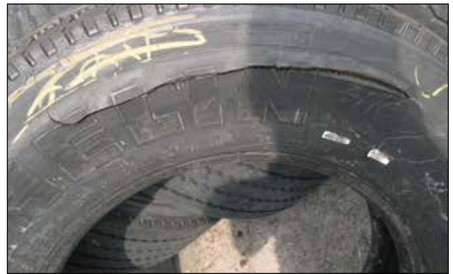
Rupture due à l'usure fatigue ou « zipper »
