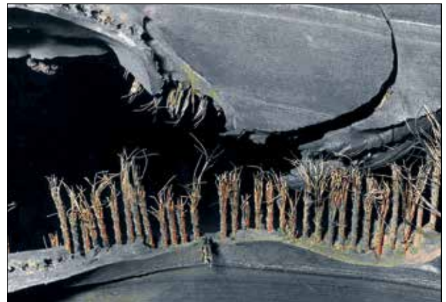
EFFET : Tout dommage qui permettra à la carcasse de s'oxyder
