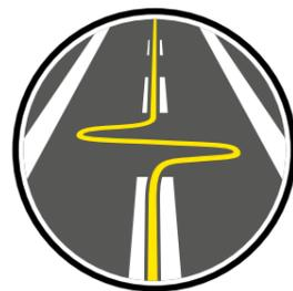
道路の段差や継ぎ目など通過した時、あるいは急加速時に起こる。進行方向は変わらないがハンドルが瞬間的に激しく左右に振られる現象。
