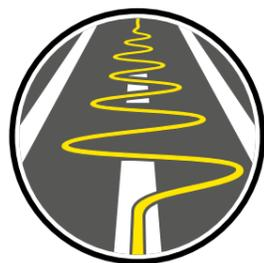
時速100キロ以下で小刻みに左右方向に連続して振動する現象。
