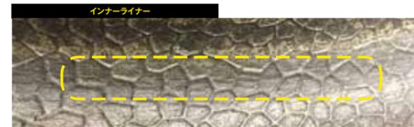
補修をする前にインテリア側のランフラットまたは過度のたわみによる損傷がないか確認してください。
