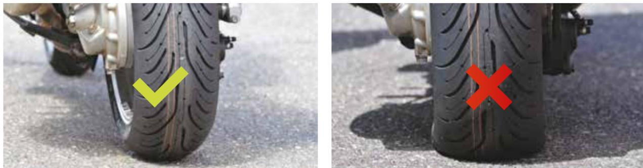
走行直後に点検する場合、タイヤが温まった状態ではタイヤの内圧が上昇していますので、決して減圧調整は行わないでください。
