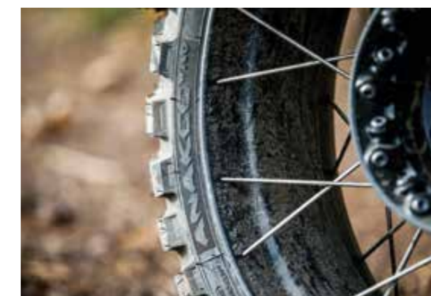
チューブレス (TL) スポークリム: スポークが端に固定されることでリムの中央を貫通しておらず、気密性が保持されている。
