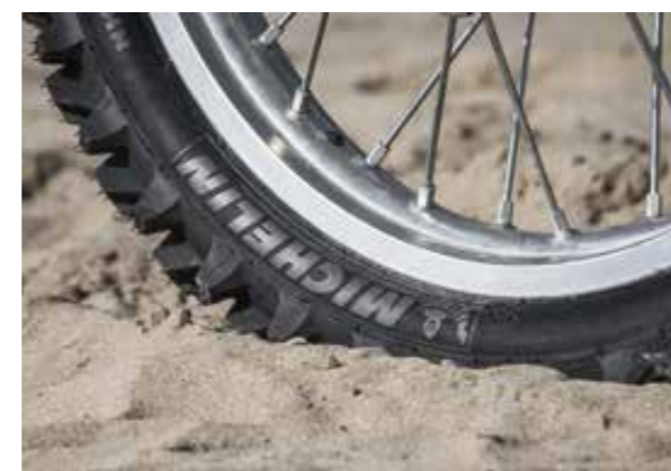
チューブタイプ (TT) リム: スポークがリムの中央を貫通している。
