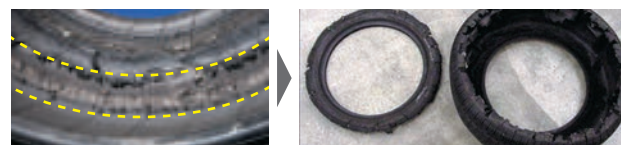
タイヤの内側がこすれ、損傷を受けたタイヤ(外見からはわかりにくい) 内側に損傷を受けた状態で走行し続けたためにバーストしたタイヤ
