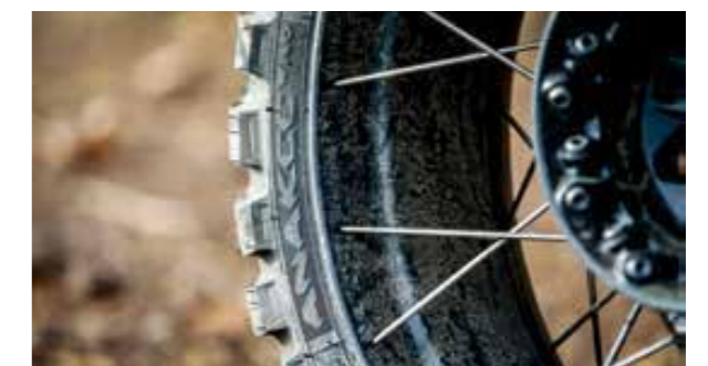
チューブレス (TL) スポークリム： スポークが端に固定されることでリムの中央を貫通しておらず、気密性が保持されている。
