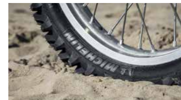
チューブタイプ (TT) リム： スポークがリムの中央を貫通している。
