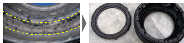
タイヤの内側がこすれ、損傷を受けたタイヤ(外見からはわかりにくい)
