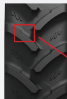
Décrochage barrette pour optimiser la traction et l'auto-nettoyage
